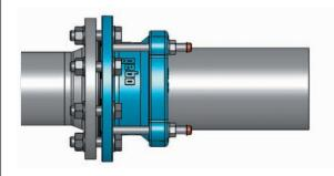
Шестигранные гайки затянуть по часовой стрелке. Момент затяжки – см. в табл.
